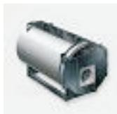
Водогрейный котел Vitomax 100-LW с максимально допустимой температурой подачи 115 °C, рабочим давлением 6, 10 бар, и диапазоном тепловой мощности от 0,65 до 6 МВт (тип M148).
