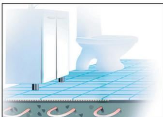
Для регулируемой сети отопления пола влажных помещений задается кривая регулирования, при которой пол отапливается и летом. Этим устраняются влажность и запахи. Также с позиции комфортности более приятно, когда плиточное покрытие пола всегда немного теплое.
