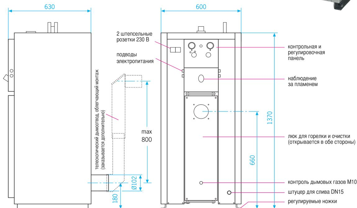
Котел Arimax 17 S - проверенный и безопасный, имеющий высокий КПД котел на жидком топливе или газе. Дополнительно можно заказать телескопический дымоотвод, облегчающий монтаж в ограниченном пространстве
